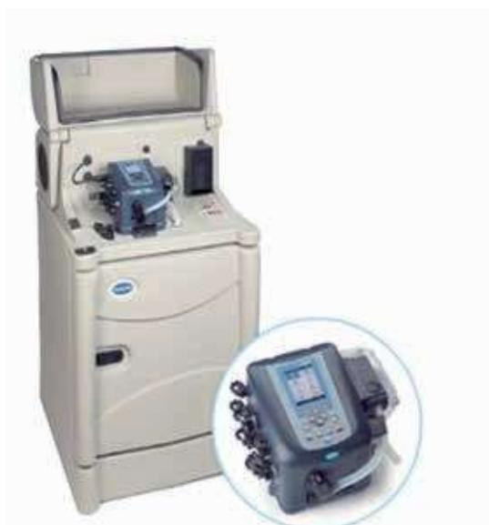
全天候冷藏采样器，能够保证水样的保存温度在4°C。压缩机放在了采样器的顶端，可避免硫化氢和其他比空气重的腐蚀性气体对其造成的损害。采样器配备的高强度、抗化学腐蚀的外罩，能更好地保护制冷管线不受潮湿和腐蚀气体的侵害。系统的感应器通过对蒸发器的温度、环境空气的温度、样品液体的温度的连续监测，由微处理器控制水样室的升温。全天候冷藏式水质采样器提供的是对环境无害的、不含氟里昂的制冷剂。
