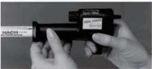
3、拿掉试剂筒的帽子安上引流管，如果是手持滴定使用180度引流管，如果使用滴定架选择90度引流管。排除气泡后使滴定器归零。
